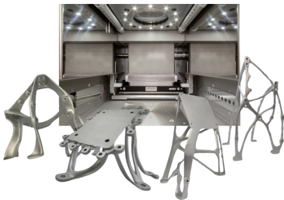
Cámara para Fabricación Aditiva mediante tecnología de PBF (Powder Bed Fusion) y muestrario de piezas fabricadas para el proyecto JUICE.
